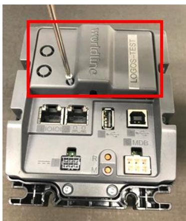
Abbildung 11: Entfernung der Plastikabdeckung
