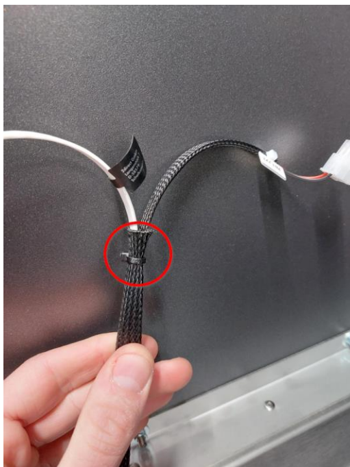
Abbildung 17: Kabelbinder an beiden Schutzschlauch-Enden anbringen
