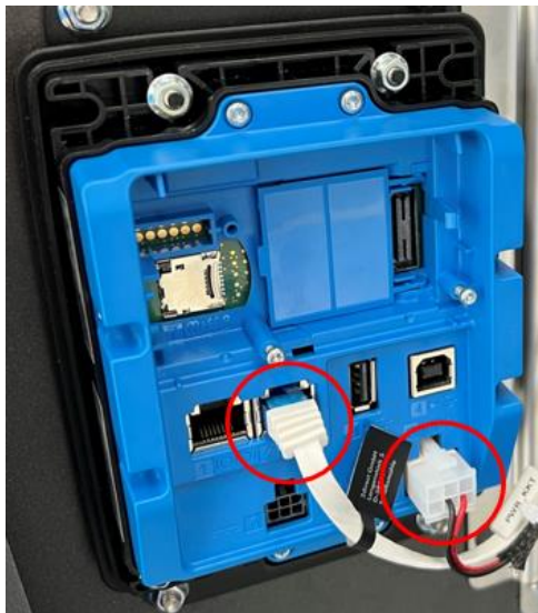
Abbildung 18: Kabel an Terminal anstecken
