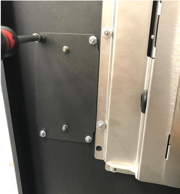
Abbildung 9: Entfernung der Metall-Abdeckung
